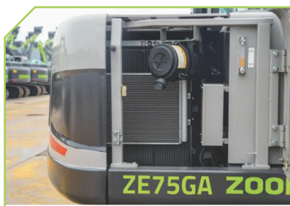
Mantenimiento del filtro de aire
