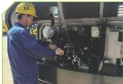
Mantenimiento de filtros de combustible y filtro de aceite del motor
